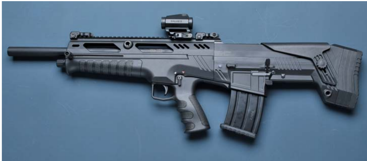
Die 3,45 kg schwere Derya N-100, hier in beiden Seitenansichten, ist aufgrund ihrer Bullpup-Konstruktion mit 50-cm-Lauf und voller, ballistischer Leistung gerade einmal 79 cm lang.
